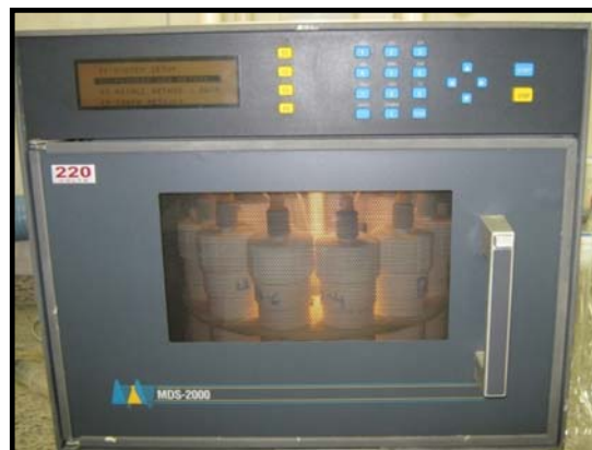
Figura 11. Amostras em processo de digestão no microondas
