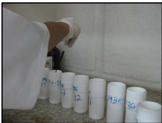
Figura 10. Adição de reagentes às amostras de camarão em tubos de teflon
