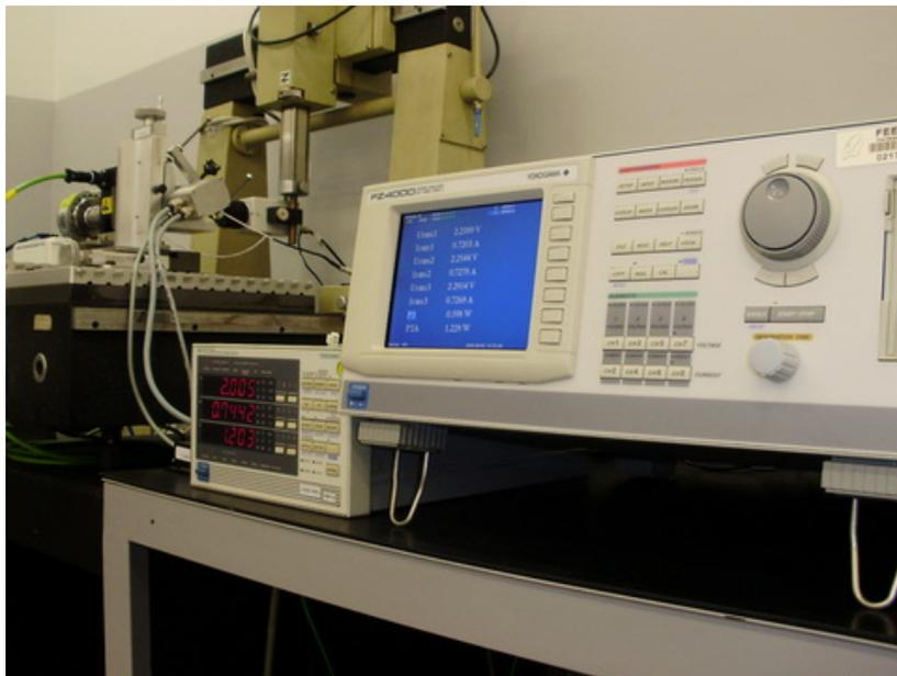
Figura 6.7: Bancada com os wattímetros WT230 e PZ4000
