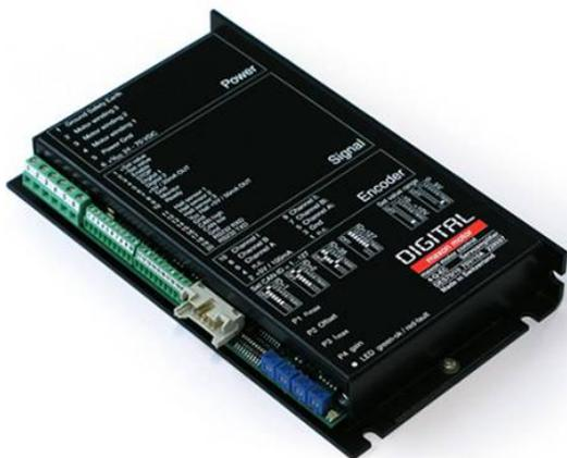
Figura 2.6: Conversor de frequência Maxon DES 70/10 [16]
