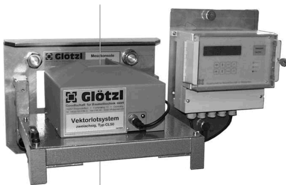
Figura 8: Exemplo de coordenômetro automatizado: a) coordenômetro disposto juntamente à base de referência e b) módulo de alimentação e transmissão com dispositivo mostrador (GLÖTZL, 2005).
