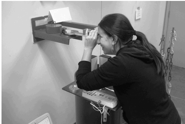
Figura 49: Procedimento de medição com coordenômetro portátil efetuado por operador treinado na Usina Hidrelétrica de Itaipu Binacional.
