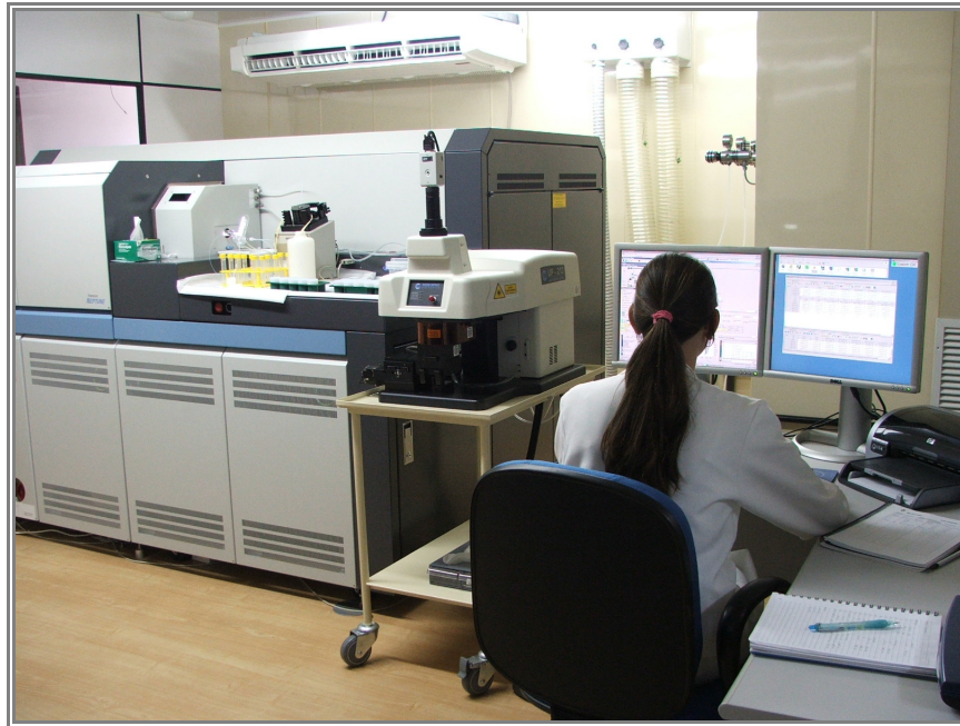
Figura 10 – O espectrômetro de massa com fonte plasma Neptune MC-ICP-MS do Laboratório de Geologia Isotópica da URGs.
