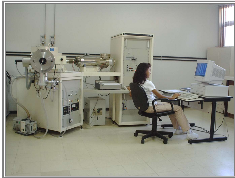
Figura 9 – Espectrômetro de massa FINNIGAN MAT 262 com multicoletores, utilizado no laboratório Pará-Iso da UFPa.
