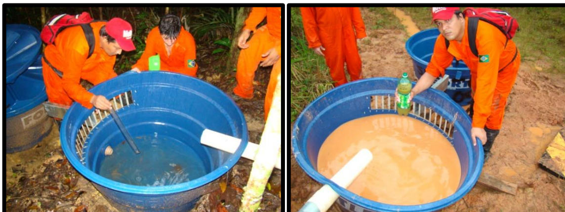
Figura 22. Leitura do volume de água e coleta do material erodido (água e sedimentos)
