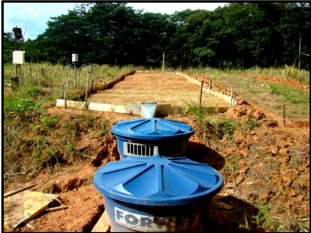
Figura 16. Parcelas coletoras de solo e água com solo descoberto instalada na Jazida 21.
