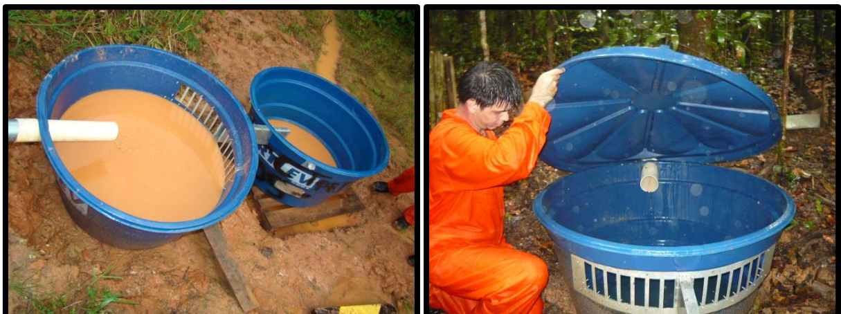
Figura 19. Calha coletora de água e sedimentos, Caixas de água de 500 L e divisor tipo Geib.
