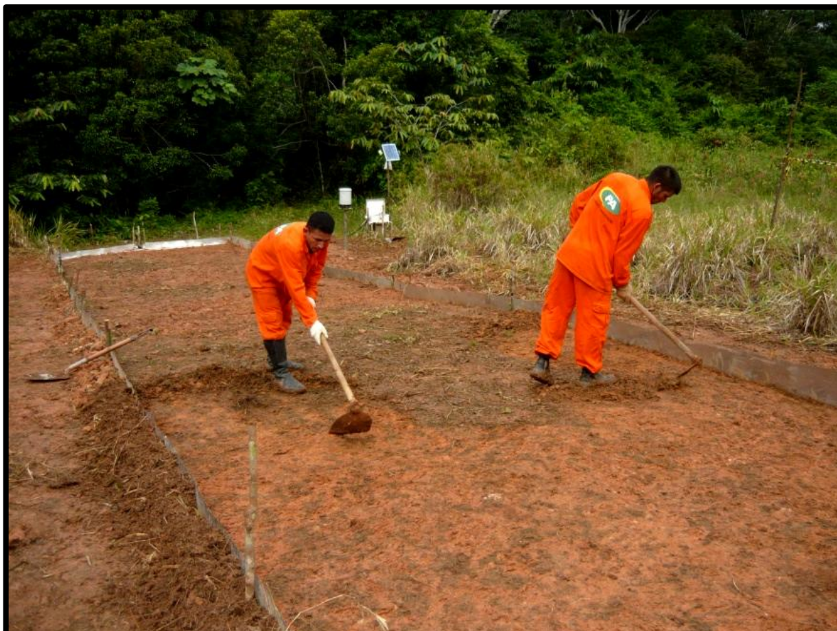
Figura 15. Capina manual e retirada dos três primeiros centímetros do solo para instalação das parcelas coletoras padrão de erosão na Jazida 21 da Base de Operações Geólogo Pedro de Moura - Coari - AM.
