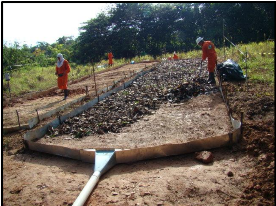
Figura 17. Parcelas coletoras de solo e água com liteira de floresta primária adjacente instalada na Jazida 21.
