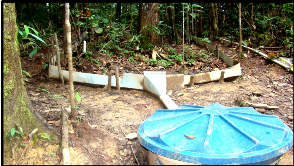
Figura 18. Parcela coletora de solo e água instalada em floresta primária adjacente.
