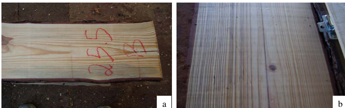
Figuras 9 - Marcação do direcionamento da medula na prancha principal: (a) visualização da medula e (b) marcação da medula e anéis de crescimento
