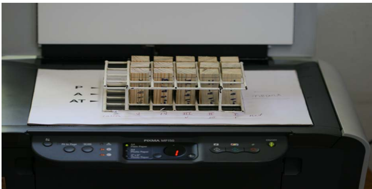
Figura 15 - Aquisição de imagens para cálculo de proporção de lenho inicial e tardio
