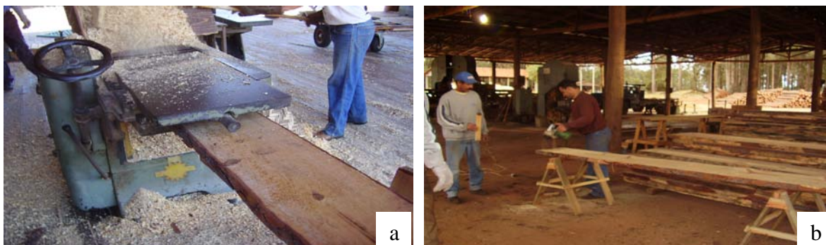
Figuras 8 - Técnicas de polimento utilizadas com desgrossadeira (a) e com lixadeira (b)
