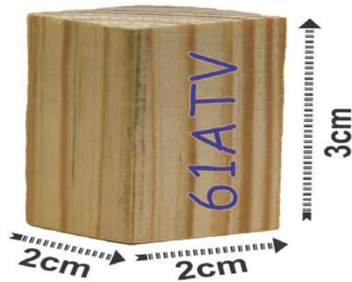
Figura 14 - Corpo-de-prova utilizado na determinação da densidade aparente da madeira
