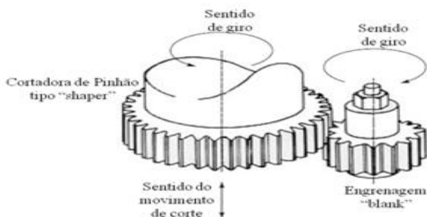
Figura 35. Movimentos no processo de cortar dentes helicoidais tipo “shaper”
