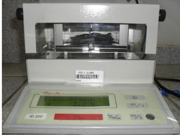
Figura 9 – Balança determinadora de umidade
