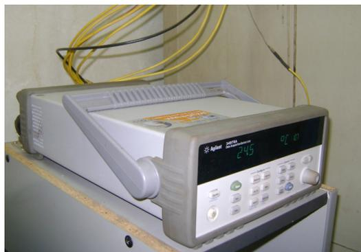
Figura 6 – Sistema de aquisição de dados (Agilent)
