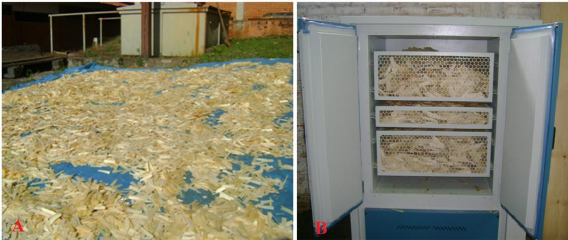
Figura 3 – A) Secagem das partículas ao ar livre B) Secagem das partículas em estufa com renovação e circulação de ar
