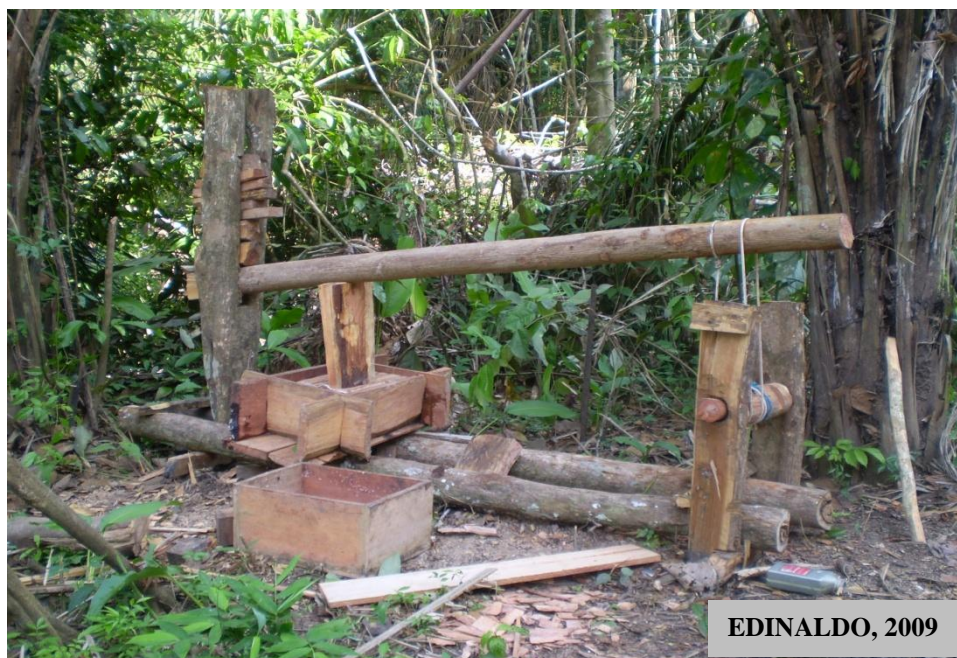
Figura 6 - Prensa rústica utilizada na fabricação de blocos de CVP, Lábrea/AM, 2009.
