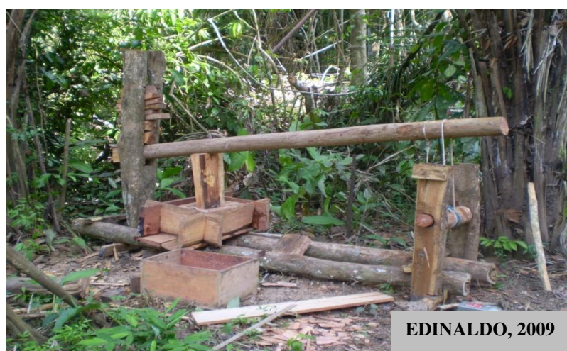
Figura 30 – Prensa para fabricação de CVP. Lábrea/AM, 2009.
