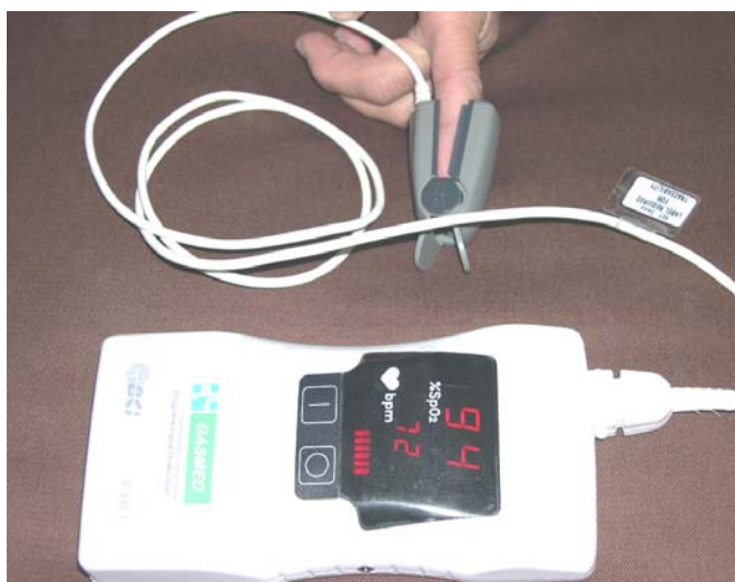
Figura 17 – Oxímetro de pulso portátil empregado durante o protocolo experimental.
