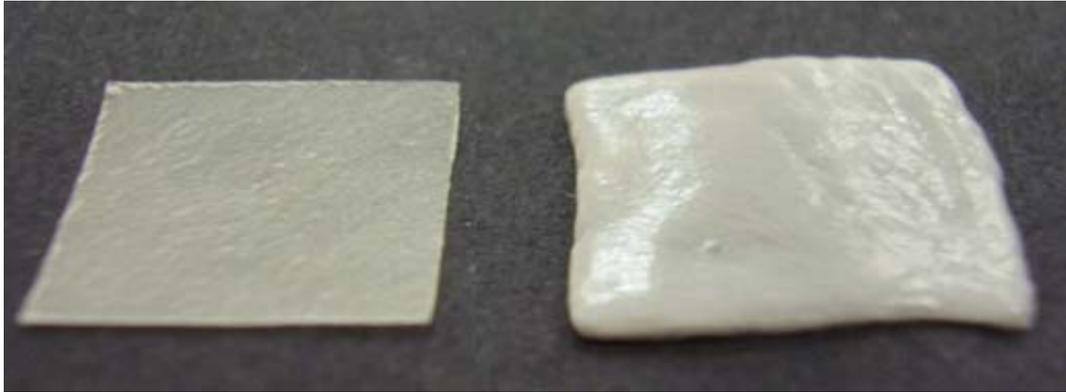
Figura 9 - Imagem do filme 80:20, seco (a) e intumescido (b) após imersão por 180 minutos em FSG.
