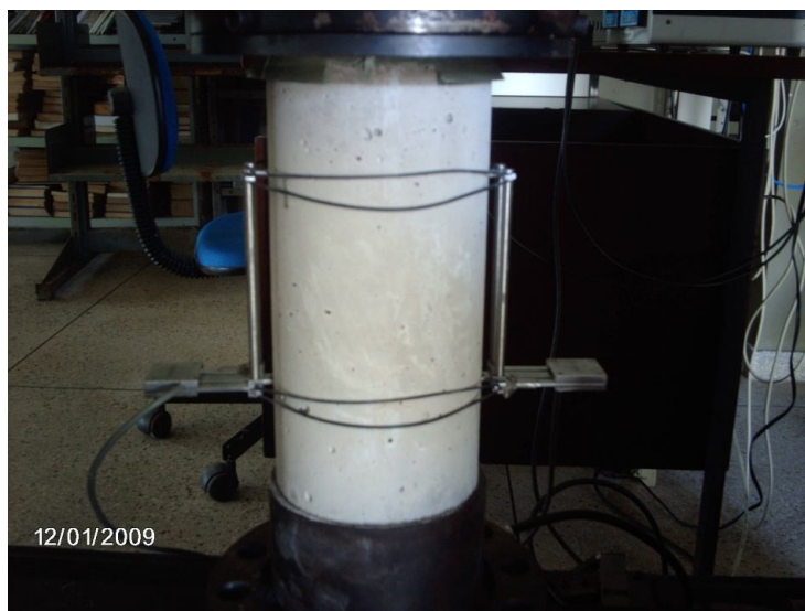
Figura 5.2: Corpo-de-prova instrumentado com extensômetros elétricos.
