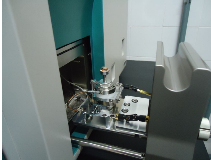
Figura 6.11: Amostra acoplada no microscópio para ensaio.
