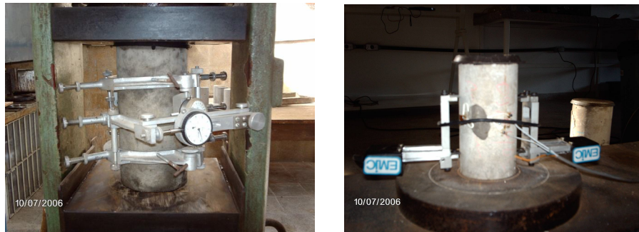
Figura 4.5: Corpos-de-prova dispostos para a realização do ensaio de módulo de elasticidade.
