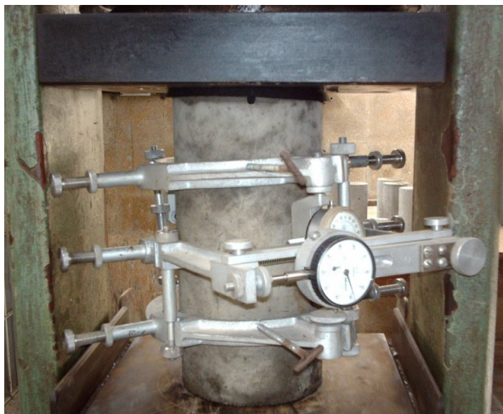
Figura 3.2: Corpo-de-prova instrumentado com extensômetros mecânicos.
