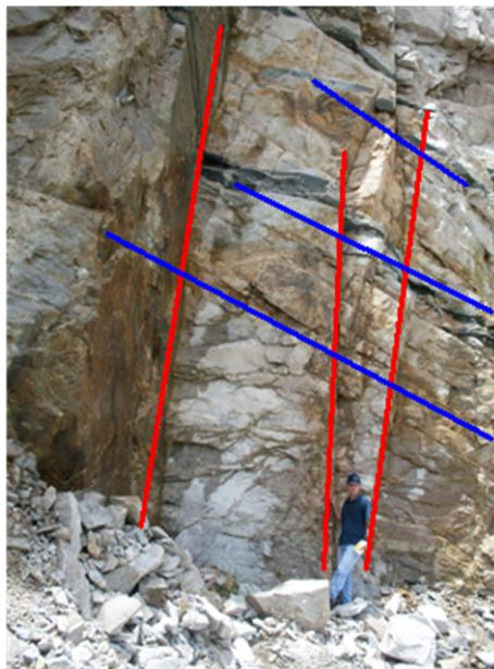
Figura 2.4 - Família de fraturas F2 com direção N-S (em azul) e família de fraturas F3 com direção NE-E (em vermelho), ortogonais entre si (Fonte: Santos, 2009).
