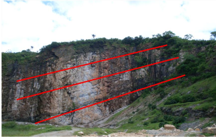
Figura 2.3 - Famílias de Fraturas F1 na direção NWW-SE (Fonte Santos, 2009)
