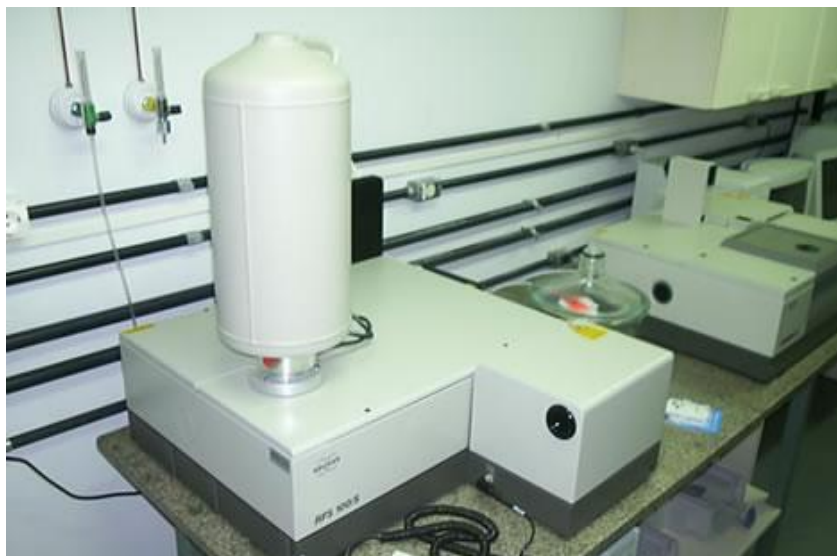
Figura 4.2.: Fotografia do espectrofotômetro FT-Raman
