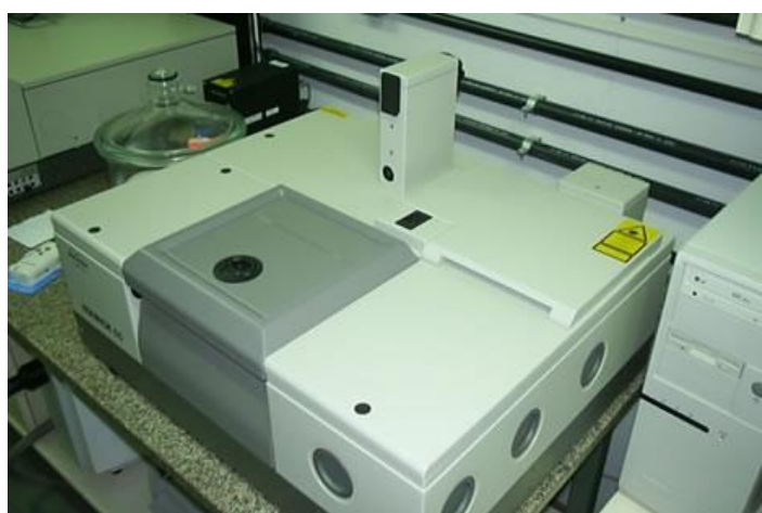
Figura 4.4.: Fotografia do espectrofotômetro FT-IR
