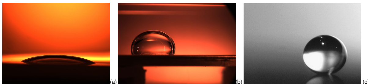
Figura 7: (a) Superfície hidrofílica; (b) Superfície hidrofóbica; (c) Superfície superhidrofóbica.
