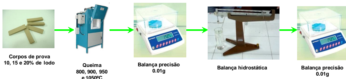
Figura 23 - Procedimento utilizado para determinação da massa específica aparente e porosidade aparente
