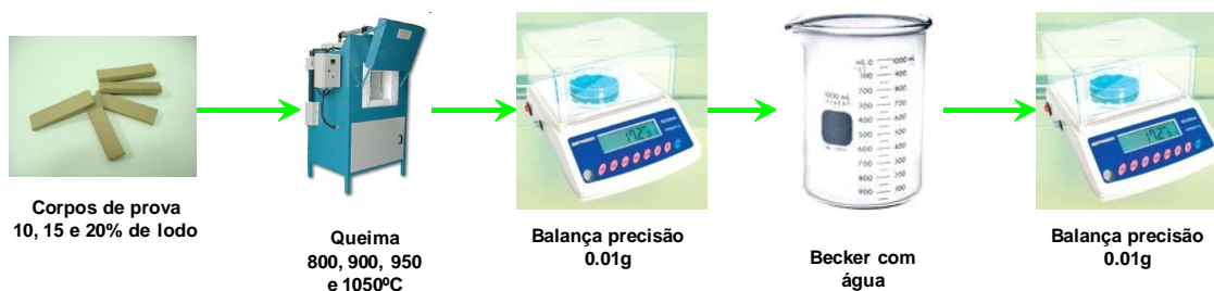
Figura 21 - Procedimento utilizado para determinação da absorção de água
