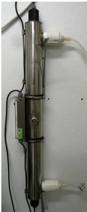
Figura 13 – Fotorreator em aço inox utilizado na desinfecção da água de chuva.
