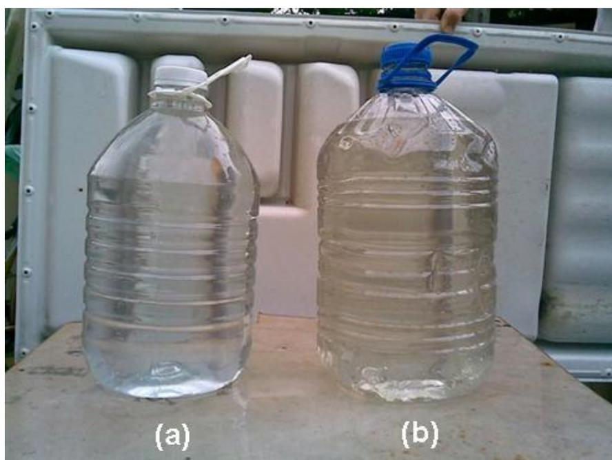
Figura 19 – Amostra de água coletada no dia 16/11/2009 por precipitação direta (a) e por drenagem de telhado (b) na região do Boa Vista.
