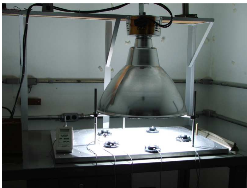
Figura 67 - Foto de ensaio ambiental de exposição a radiação ultravioleta.
