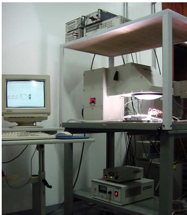
Figura 37 - Imagem do sistema de caracterização I x V do LAS/INPE.
