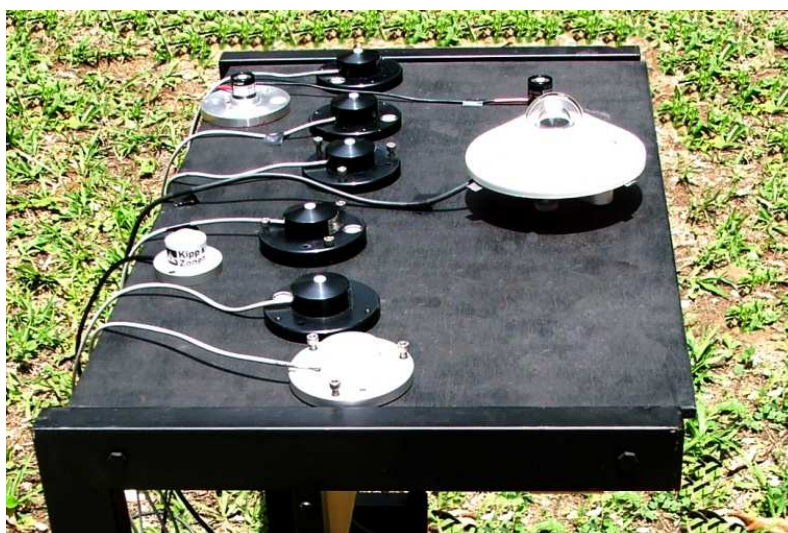
Figura 56 - Bancada de calibração ao ar livre para calibração de protótipos de radiômetros desenvolvidos no LAS.
