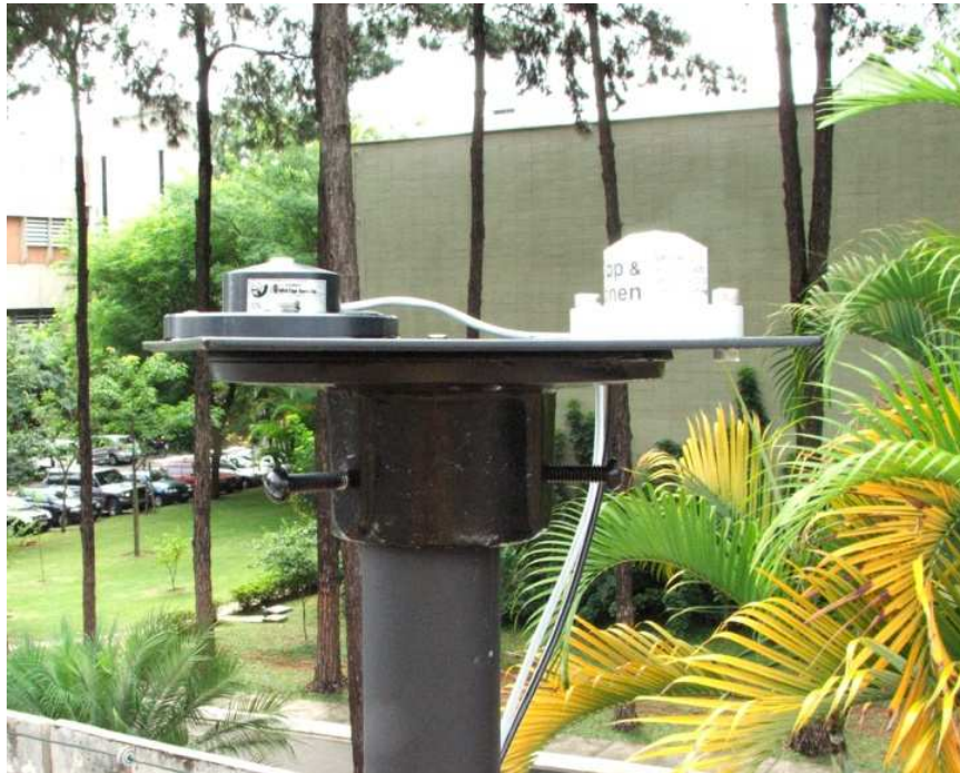
Figura 68 - Foto da plataforma de teste de coleta de dados de radiômetros.
