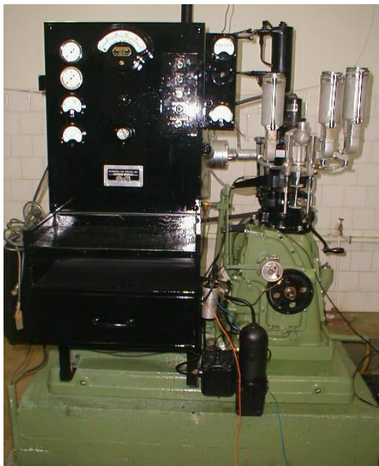
Figura 4.6: Foto do motor padrão ASTM CFR do Laboratório de Motores da UFRGS
