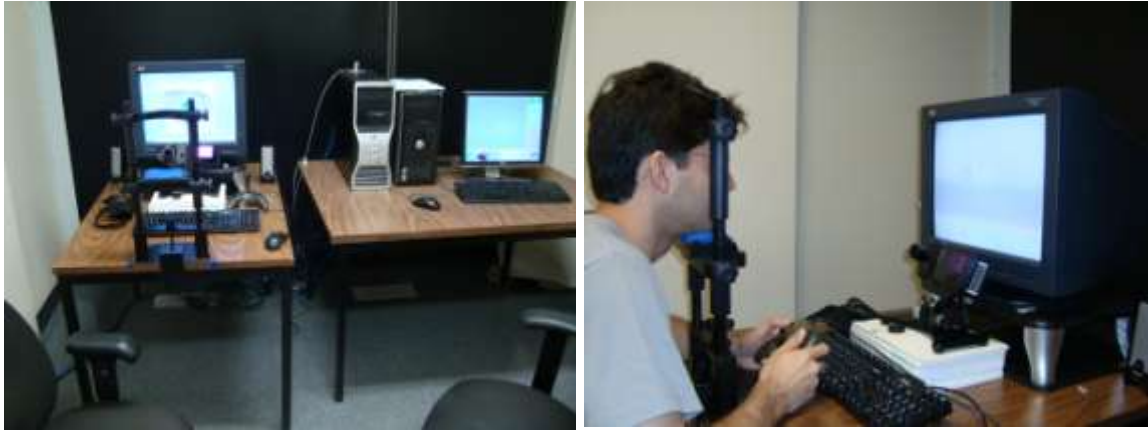
Figura 7. À esquerda é mostrado o Sistema EyeLink 2000 usado para gravar a posição dos olhos durante os experimentos e à direita um participante posicionado sobre o apoiador de queixo e usando um controle para realizar as respostas.
