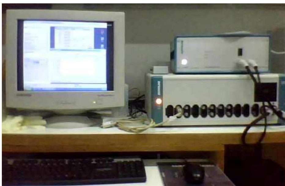
Figura 3.2: Potenciostato/galvanostato Metrohm, modelo Autolab – PGSTAT 302, conectado a um microcomputador.
