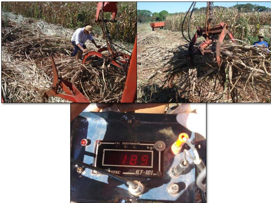
Figura 11. Fotos ilustrando a pesagem dos colmos na unidade experimental para determinação da produtividade por área utilizando célula de carga acoplada em trator.
