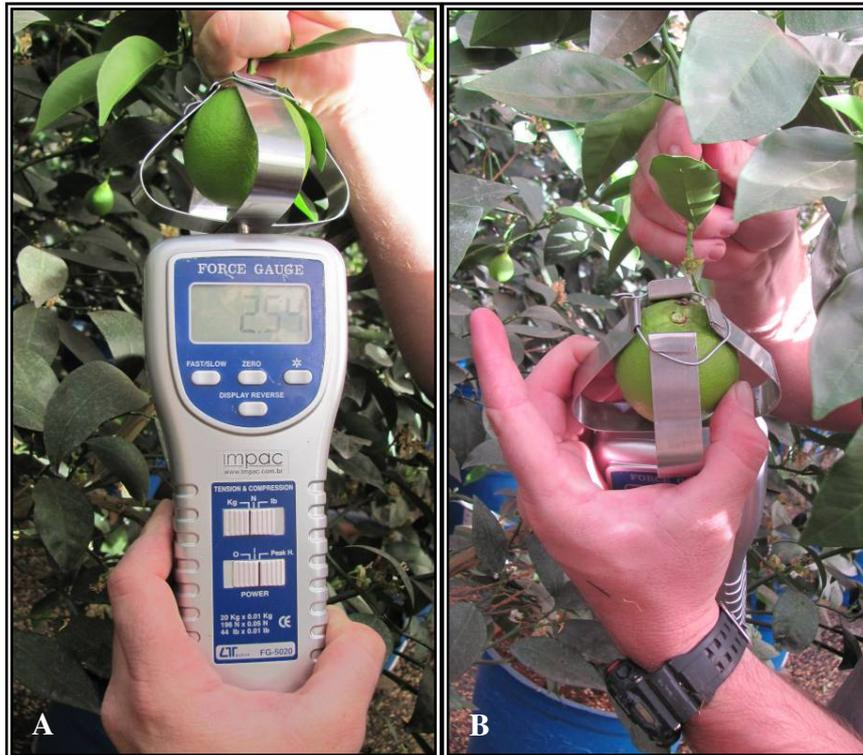
Figura 4: Dinamômetro digital eletrônico utilizado para medir a força necessária para o arranquio dos frutos (A) e fruto destacado do pedúnculo (B).
