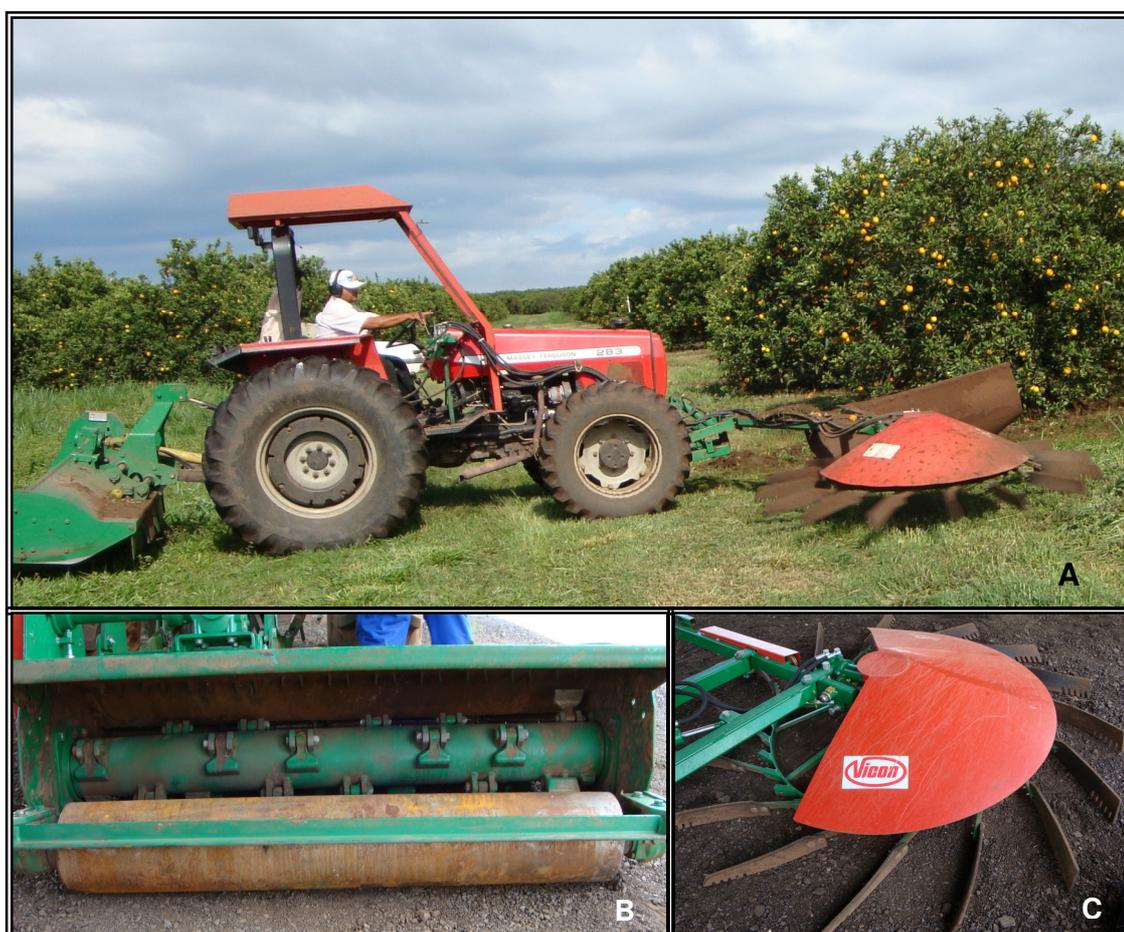
Figura 1: Equipamento conjugado rastelo mecânico e trincha utilizado para reduzir fonte de inóculo de *Guignardia citricarpa* (A). Trincha utilizada para triturar o material vegetal (B) e rastelo mecânico utilizado na remoção de folhas cítricas sob a copa das plantas (C).
