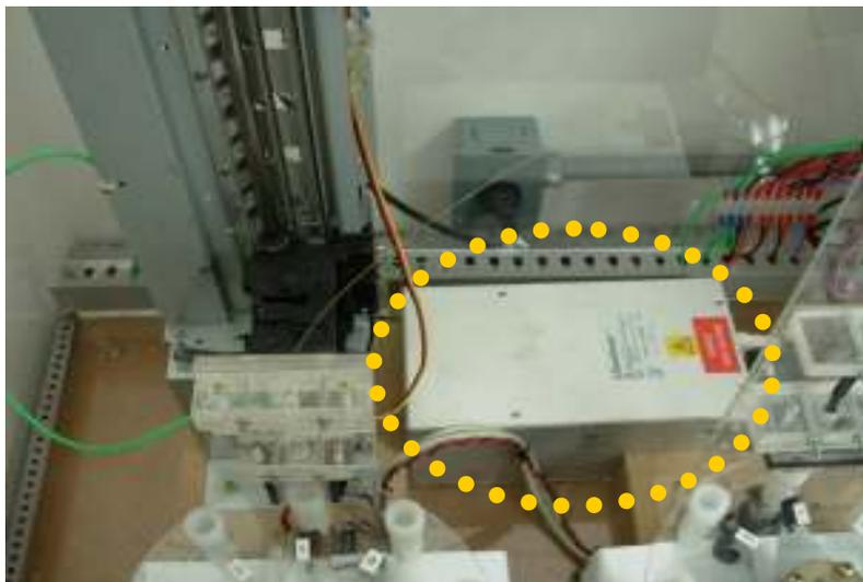
**Figura 19:** Fonte de alta tensão empregada no sistema CE-C<sup>4</sup>D desenvolvido.
