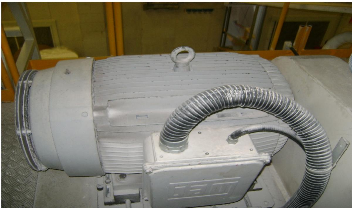
Figura 7 - Motor de 250 CV de acionamento do moinho antigo
