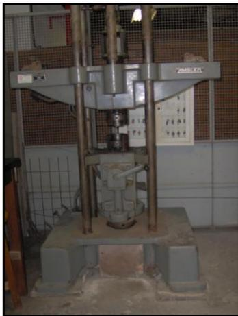
**Figura 3.42** – Prensa hidráulica utilizada.
