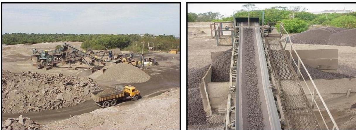
**Figura 2. 41** – Planta de Britagem, classificação e separação magnética (SILVA e LEITE, 200-?).
