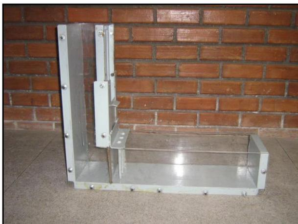
**Figura 3.33** – Caixa – L fabricada para a execução do ensaio.
