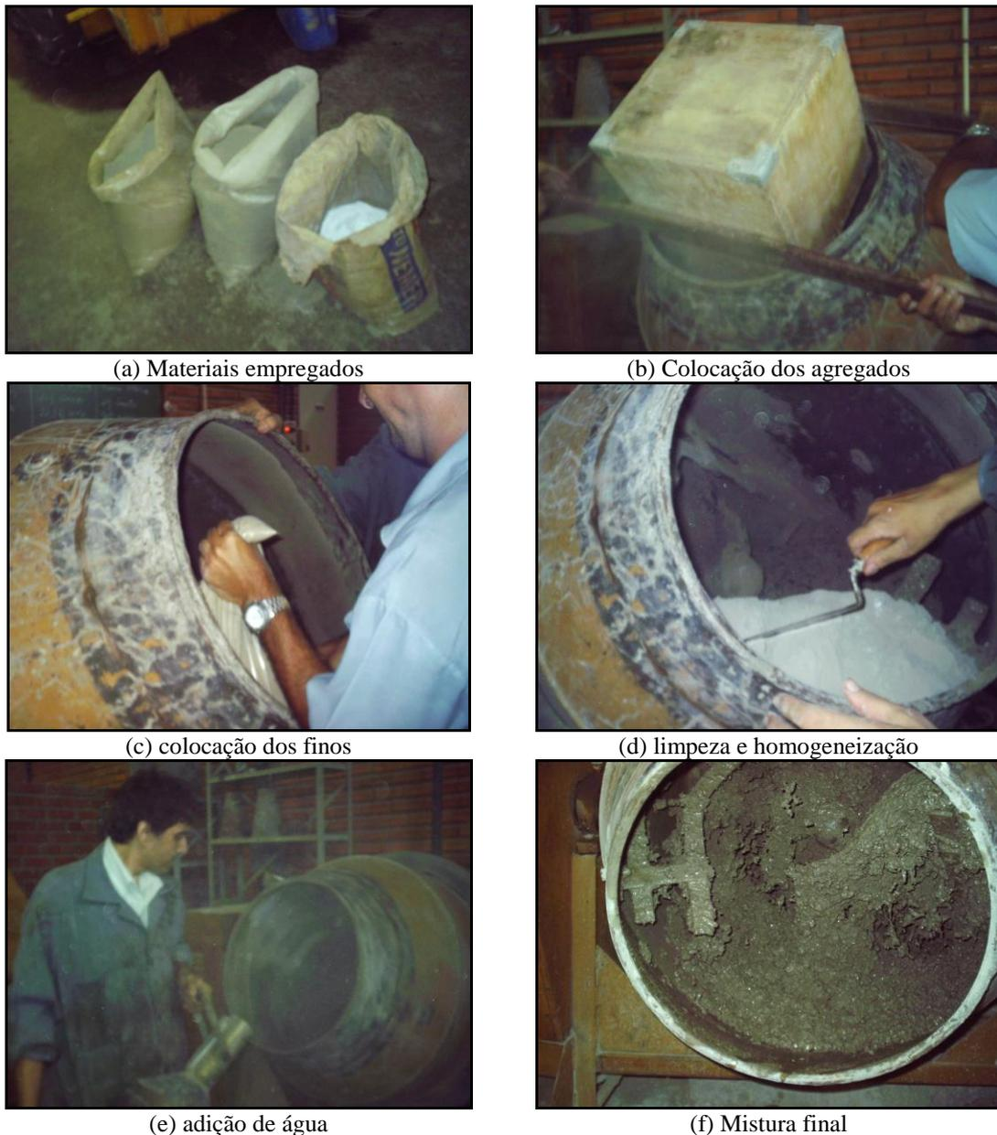
**Figura 3.28** – Sequência de colocação dos materiais na betoneira.
