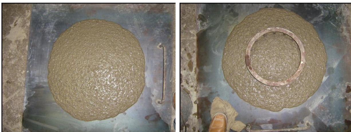
(a) *Slump flow*(b) *Slump flow* com anel J.**Figura 4.36** – Resultados dos ensaios para CON85EALD15CV\_38\_1,35.
