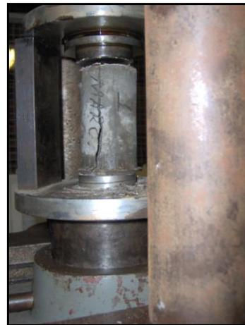
**Figura 3.43** – Corpo-de-prova no momento da ruptura.
