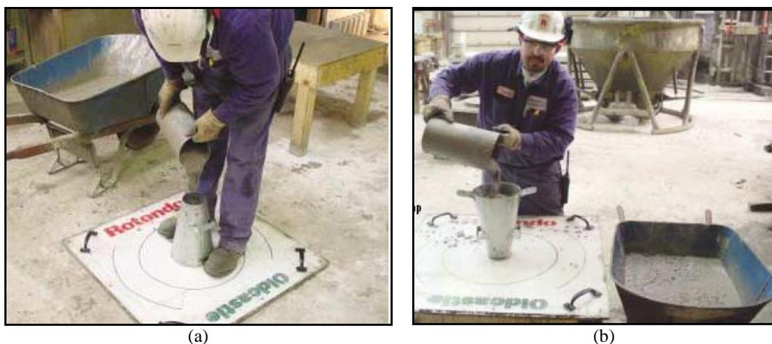
**Figura 2.23** – (a) O cone e o técnico estão firmemente plantados no piso. (b)- Técnico executando o ensaio de *slump-flow* invertido em uma base elevada (RAMSBURG, 2003).
