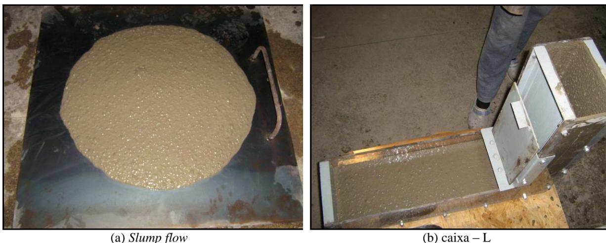
**Figura 4.29** – Resultado do ensaio de espalhamento e caixa – L para CON100EALD\_42\_1,20\_0,40.
