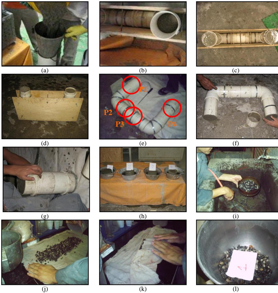
**Figura 3.38** – Sequência de execução do ensaio do tubo U.
