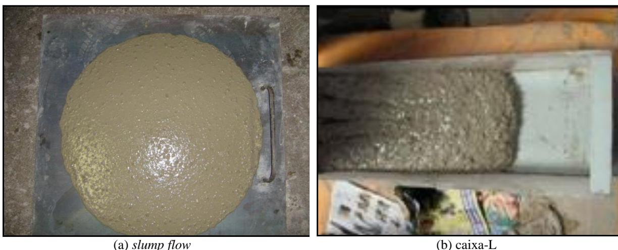
**Figura 4.41** - Ensaio para CON100CAL\_42\_1,20\_0,40.
