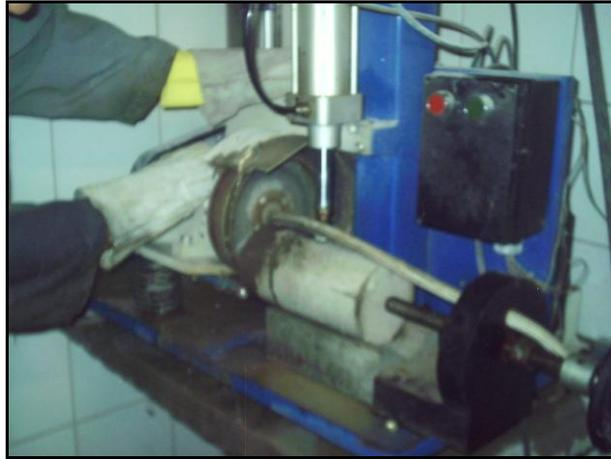
**Figura 3.41** – Retificação dos corpos-de-prova para o ensaio de resistência à compressão.
