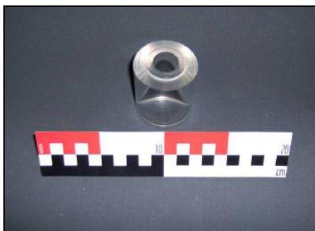
**Figura 3.23** – Mini – Slump (CALMON *et al.*, 2006).
