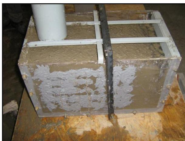
**Figura 4.31** – Ensaio da caixa de preenchimento.
