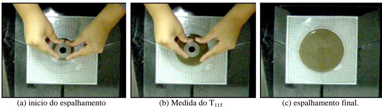
**Figura 4.16** - Sequência de obtenção dos valores de  $T_{115}$  e espalhamento final para P85EALD15CV.
