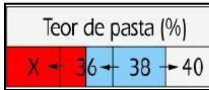
**Figura 3.26** – Esquema de obtenção do teor ótimo de pasta quando o concreto com teor de pasta igual a 38% atinge os requisitos de auto-adensamento.
