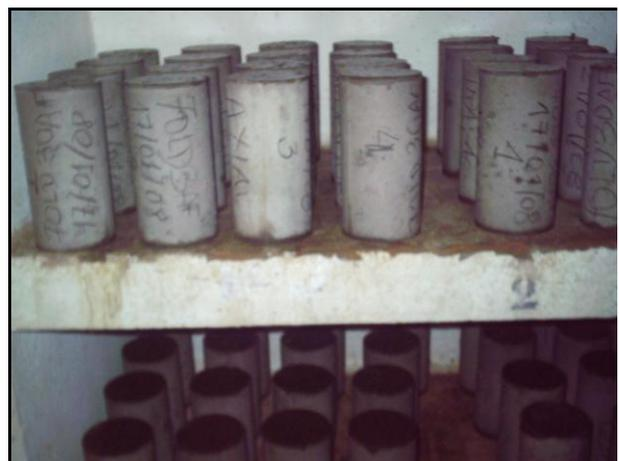
**Figura 3.40** – Cura dos corpos-de-prova em câmara úmida.
