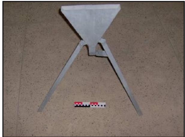
**Figura 3.18** -Dimensões do funil V (EFNARC, 2002).
