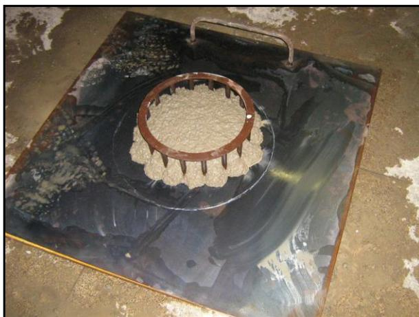
**Figura 4.26**– Ensaio de *slump flow* com anel J para CON100EALD\_38\_1,20\_0,40.
