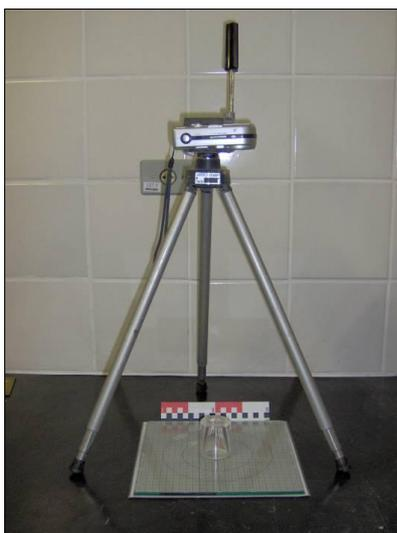
**Figura 3.24** – Montagem da câmera para a realização dos ensaios (CALMON *et al.*, 2006).
