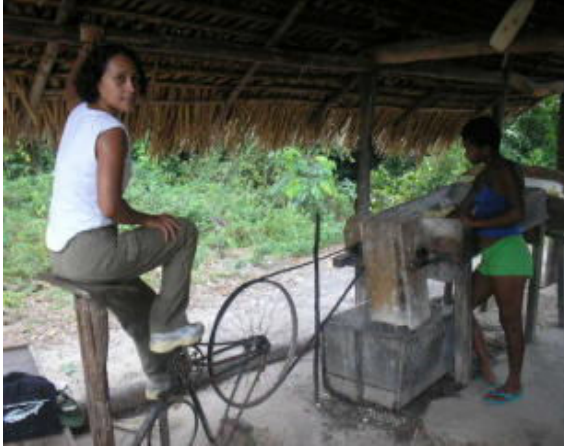
Figura 14 – Máquina de moer mandioca movida à força humana.
