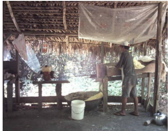
Figura 15 – Máquina de moer mandioca com motor movido à gasolina.
