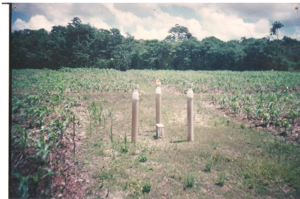
FIGURA 4- Pluviômetros instalados dentro da área experimental, em Cumaru, Município de Igarapé-Açu (PA). ( Foto: Mário Lopes).
