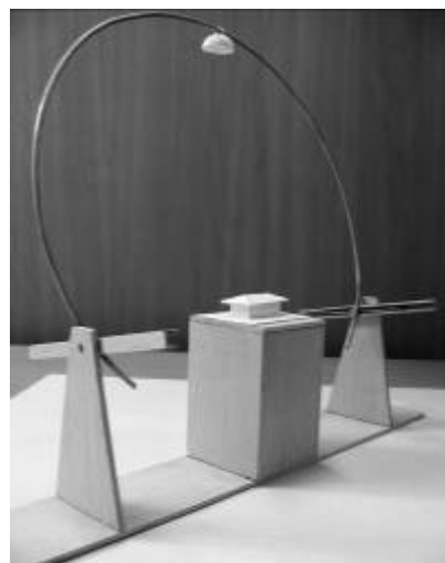
Figura 177: Maquete do Heliodon com um arco Fonte – SOUZA, 2004
