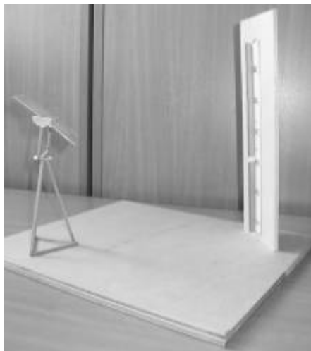
Figura 176: Maquete do Heliodon de régua Fonte – SOUZA, 2004
