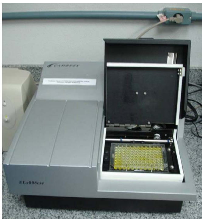
Figura 21– Placa posicionada no leitor de microplacas para obtenção das densidades ópticas das amostras.
