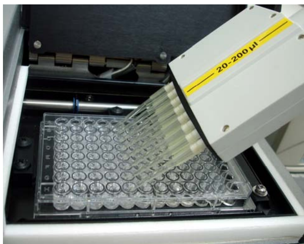
Figura 7– Preparo para realização do teste para quantificação de endotoxina; colocação do reagente cinético cromogênico (LAL).
