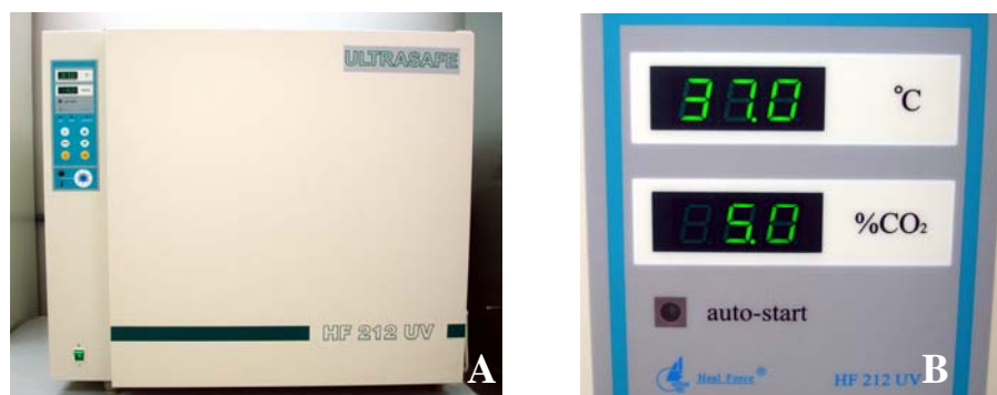
Figura 9 – Estufa utilizada para crescimento celular (A). Temperatura de 37°C e concentração de CO 2 de 5% (B).
