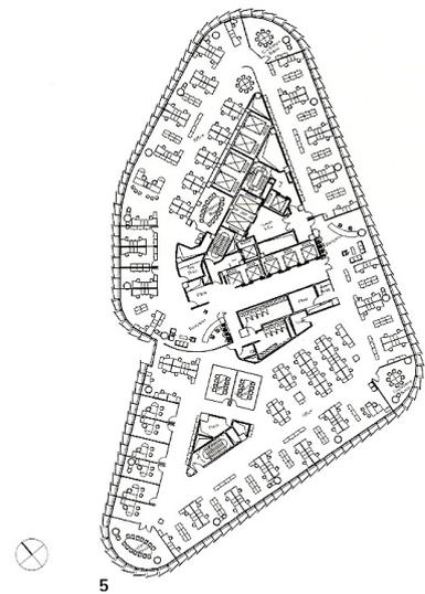
Figura 77. Edifício Bishopsgate Tower: planta de um pavimento tipo de escritórios (Fonte: Environmental Statement, 2006)
