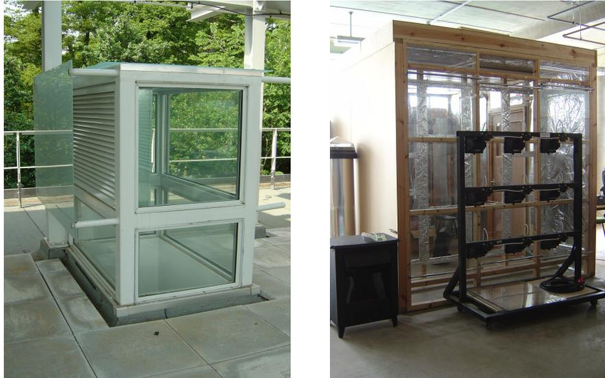
Figuras 116 e 117. *Mock-ups* para ensaio de componentes de fachadas na *School of the Built Environment* da Universidade de Nottingham, Inglaterra
