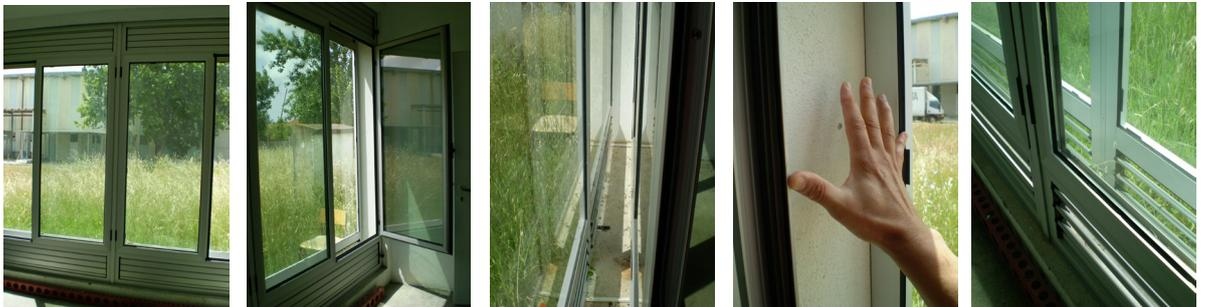
Figura 118. Instalação experimental para ensaios de fachadas duplas ventiladas no LNEC, em Portugal (Créditos: Alessandra Prata)
