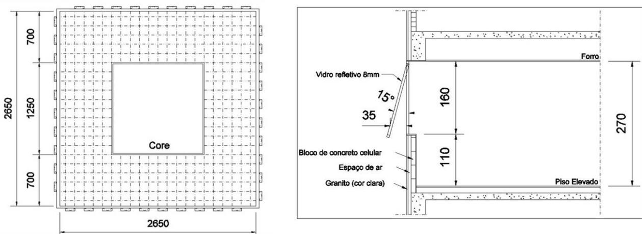
Figuras 125 e 126. Modelo de edifício proposto por Figueiredo (2007): planta e corte do pavimento tipo (respectivamente) (Figueiredo, 2007)
