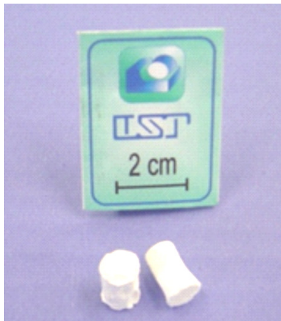
Figura 4.47 – Peças em Gradiente Funcional manufaturas pelo método de co-prensagem em molde de silicone
