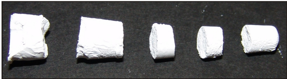
Figura 4.48 – Peça em Gradiente Funcional em formato cônico manufacturada com co-prensagem. A peça fraturou em 5 partes após a prensagem isostática
