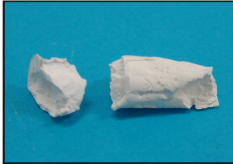
Figura 4.45 – Imagem de peça em MGF manufacturada com co-prensagem. A peça fraturou após a prensagem isostática
