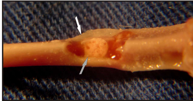
Figura 3.6 – Imagem de uma tíbia preparada para o ensaio biomecânico, a cortical contralateral à inserção do implante foi removida para expor a face do implante a ser empurrada. A seta branca indica a cortical do osso, a seta cinza indica o implante
