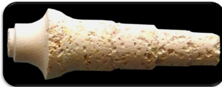
Figura 4.58 – Pino dentário em gradiente funcional, manufaturado pela técnica de co-prensagem e com acabamento realizado através de usinagem à verde, após pré-sinterização
