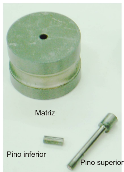
Figura 3.3 – Molde metálico utilizado para conformar os implantes em alumina porosa em formato cilíndrico
