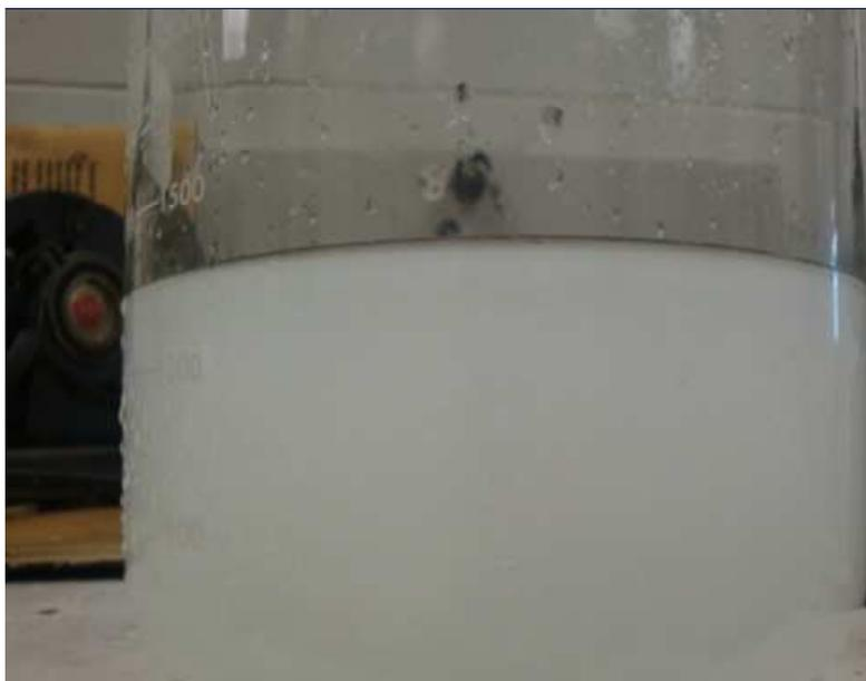
**FIGURA 17.** Suspensão de nanofibras de Curauá.
