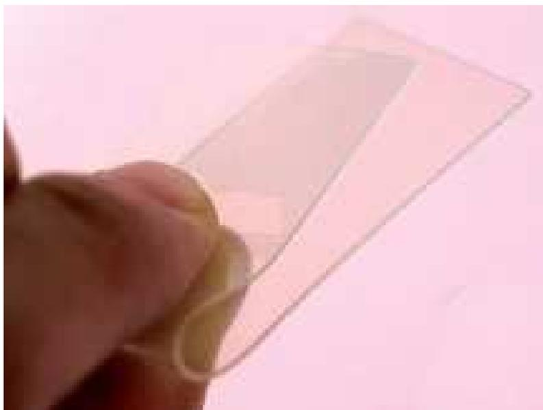
**FIGURA 8.** Nanocompósito flexível transparente reforçado com nanofibras de celulose bacteriana. Reproduzida com permissão de Nogi e Yano (2008).
