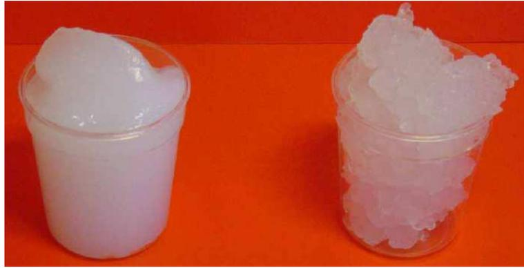
**FIGURA 4.** Imagem da celulose microfibrilada na formação de gel pela absorção de água.
