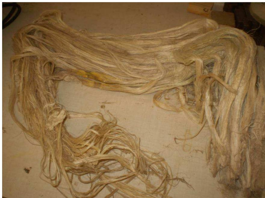
**FIGURA 11.** Fibras extraídas das folhas de Curauá.
