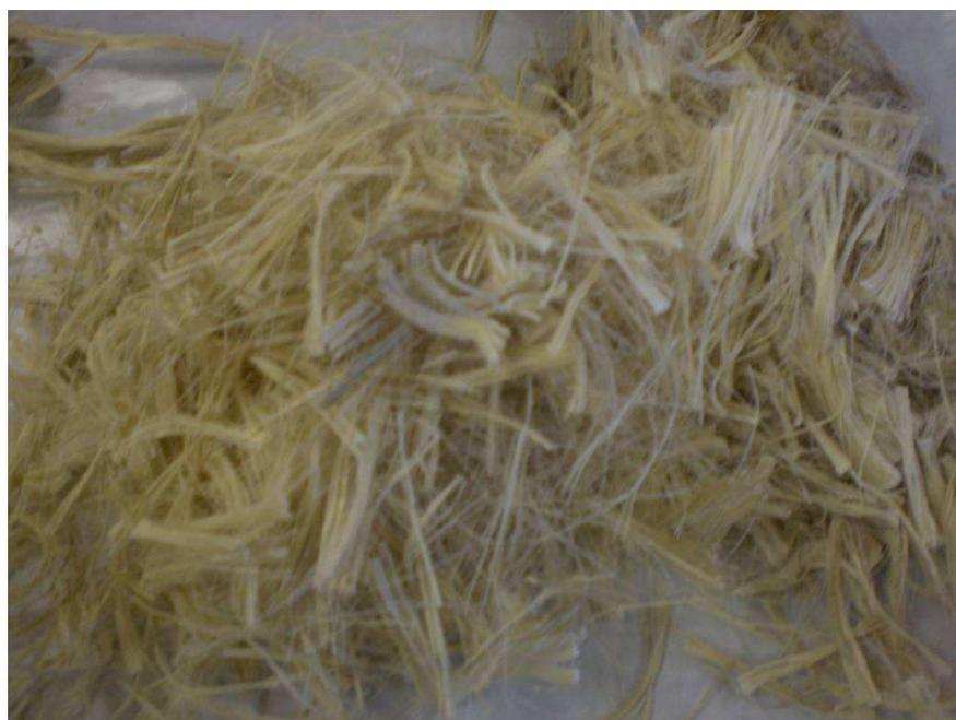
**FIGURA 13.** As fibras das folhas de curauá cortadas em 3 cm.
