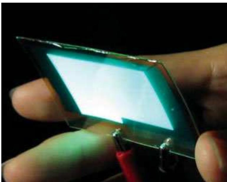
**FIGURA 7.** Luminescência de um dispositivo de OLED produzido por um nanocomposito transparente a base de celulose bacteriana (NOGI e YANO, 2008).
