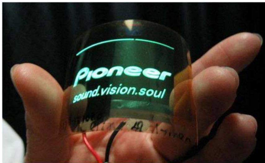
**FIGURA 5.** Luminescência de diodo orgânico emissor de luz depositado em uma camada flexível e opticamente transparente produzida com uma nanocompósito baseado em celulose de madeira (OKAHISA, 2009).
