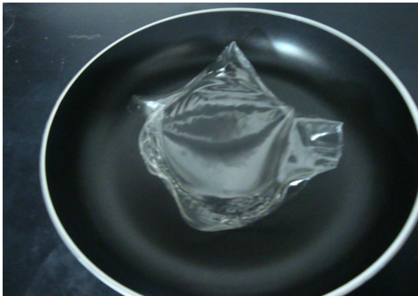
**FIGURA 18.** Preparo do filme de PVA e Compósito por *Solution Casting*.
