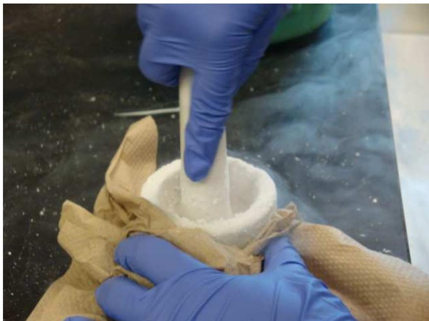
**FIGURA 16.** Trituração com nitrogênio líquido.
