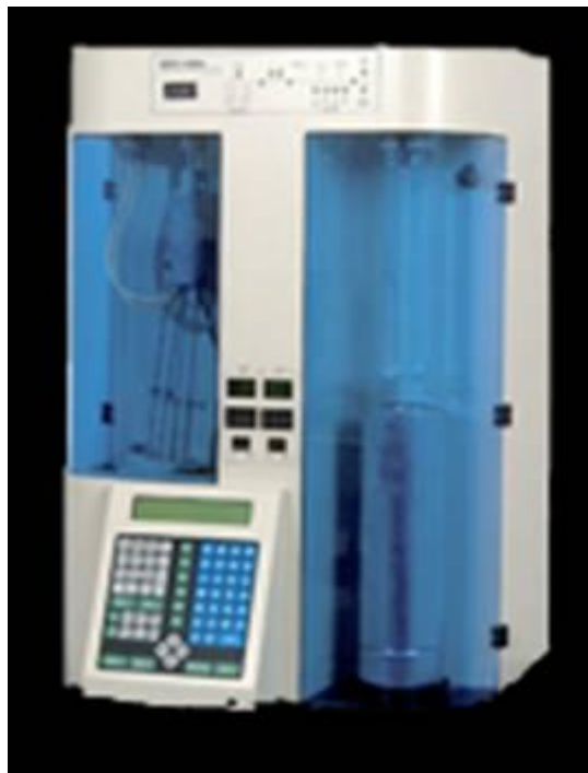
Figura 4.13 Equipamento utilizado para análise das propriedades texturais.
