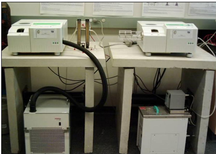
Figura 4.14 Termobalança utilizada na análise termogravimétrica.
