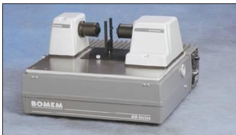
Figura 4.10 Espectrômetro de Infravermelho com Transformada de Fourier.
