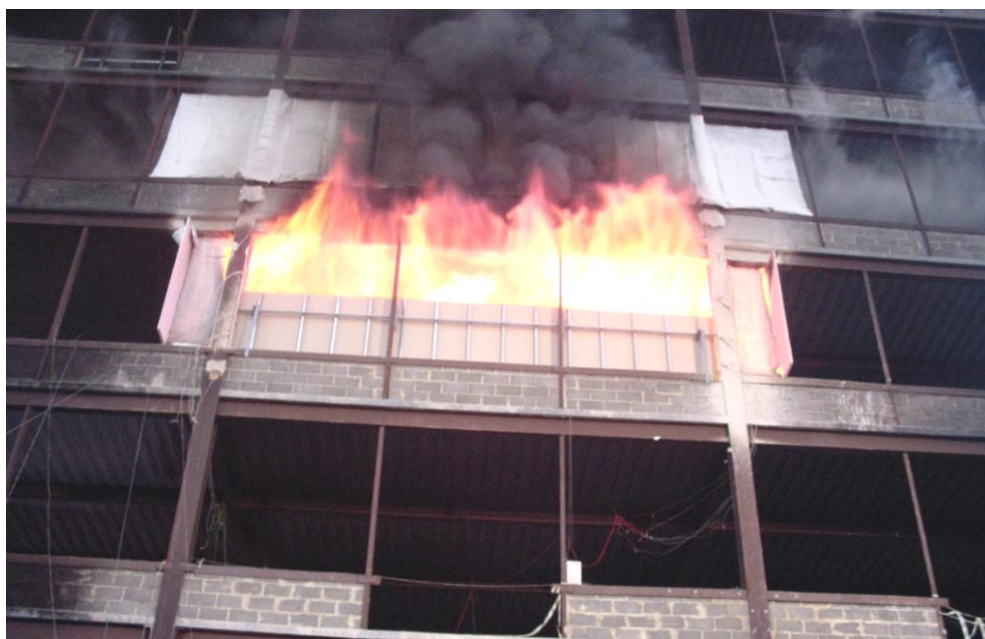
Figura 2.2 – Edifício de estrutura mista em escala real no Laboratório de Cardington para experimentos com incêndio em escala real.
