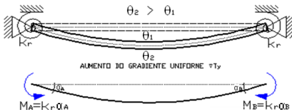
Figura 4.16 – Barra com restrição rotacional finita com gradiente uniforme de temperatura.
