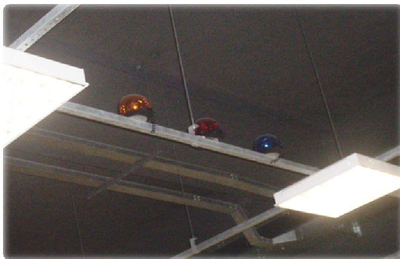
Figura 11: sinalização eletrônica: andon
