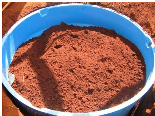
Figura 03 (b) Devolução das camadas de solo nas caixas. Fonte: Prior (2008).
