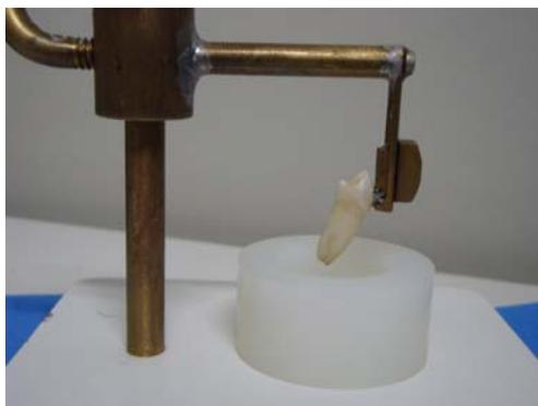
**Figura 10:** Dispositivo utilizado para a inclusão dos dentes.
