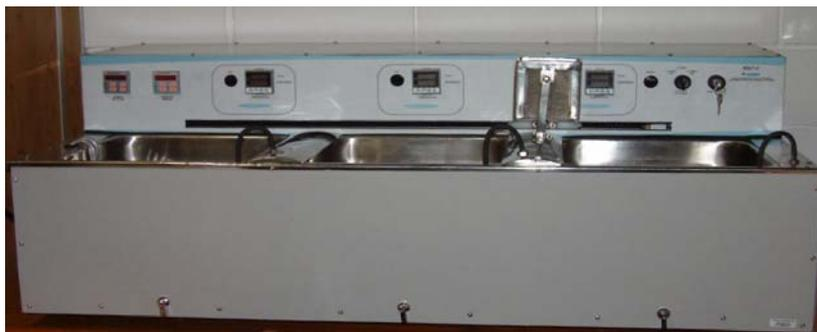
**Figura 11:** Máquina para simulação de ciclos térmicos.
