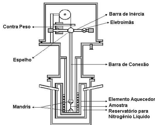
**Figura 9:** Diagrama de corte do Pêndulo de Torção.
