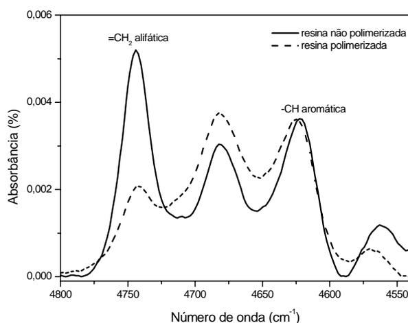
**Figura 15:** Espectros de absorção da resina composta para determinação do GC. A linha contínua representa o espectro da resina não polimerizada e a linha tracejada da resina polimerizada.
