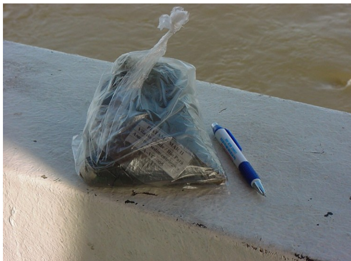
Figura 13: Amostra sedimentológica acondicionada e identificada
