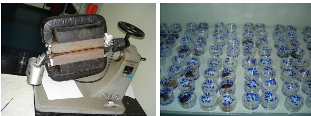
Figura 16 e 17: Separador eletromagnético IsoFrantz e amostras subdivididas.
