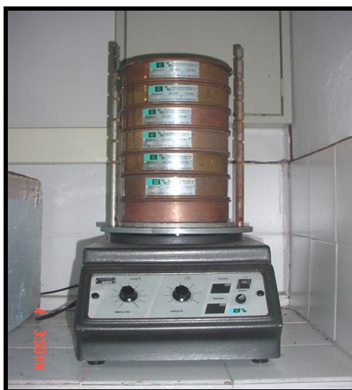
Figura 14: Peneirador vibratório e jogo de peneiras utilizadas para a separação por vibração mecânica, das classes granulométricas dos sedimentos arenosos.
