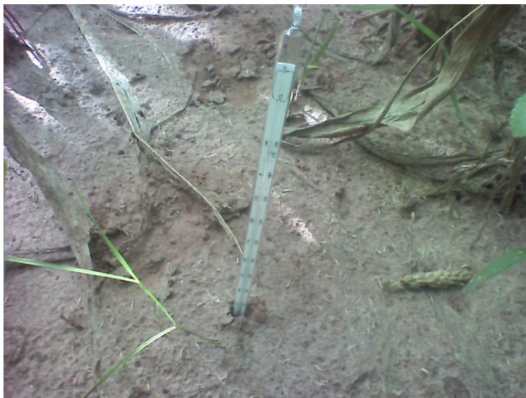
Figura 1B. Fotografia mostrando a colocação do termômetro de mercúrio utilizado para as medições de temperatura do solo.
