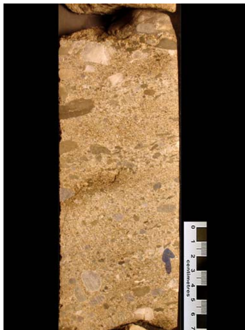
Figura 3: Arenito com estratificação cruzada acanalada, fácies Ac, granulometria muito grossa. Composição de clastos bastante variável incluindo quartzo, pelitos e fragmentos líticos.
