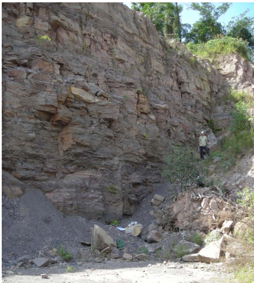
Figura 15 - Frente da lavra da mina de Meleiro apresentando estratificação planoparalela milimétrica a dessimétrica subhorizontal.
