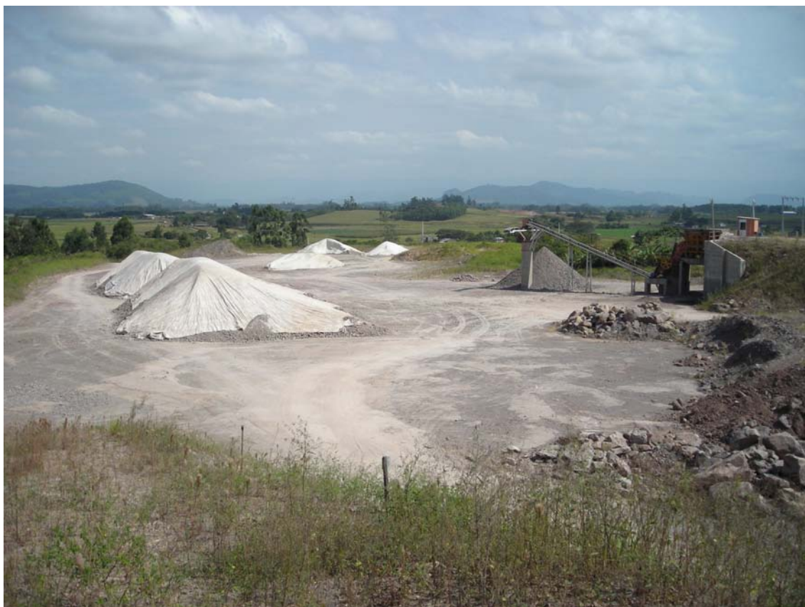
Figura 3 - Área de manuseio do material com o britador e sob a lona o material em descanso da mina de Meleiro.
