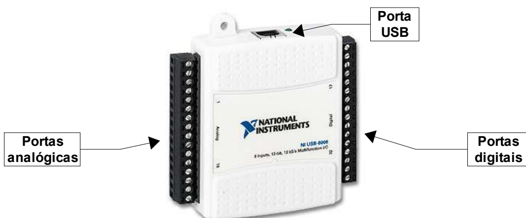
Figura 4.4 – Placa de aquisição utilizada para captura e tratamento dos dados em microcomputador.
