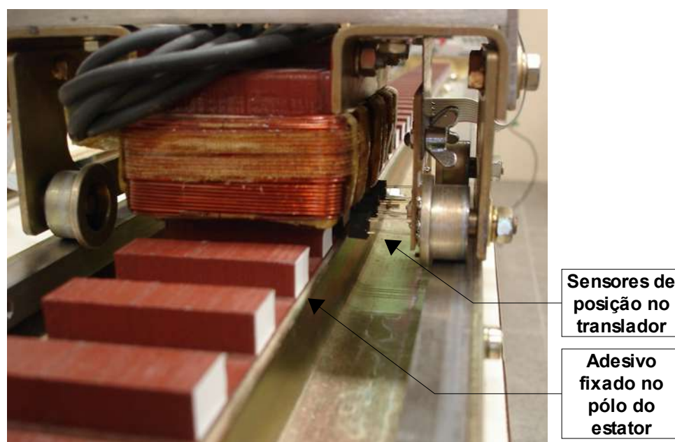
Figura 5.13 – Detalhe dos adesivos brancos fixados na face lateral de cada um dos pólos do estator, para minimizar a atenuação do sinal dos sensores de posição.
