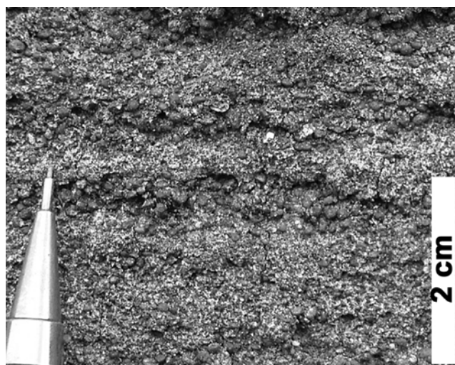
Figura 40: Arenitos finos a grossos, bimodais apresentando gradação inversa na escala de laminação. Ponto 01 (ver Figura 34 para localização).
