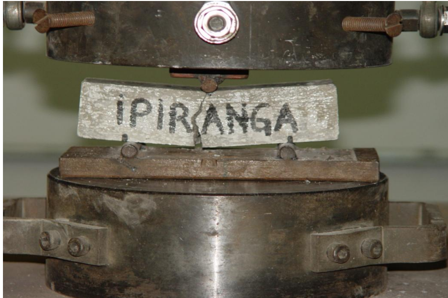
Figura 4.13: Corpos-de-prova prismáticos submetidos à tração na flexão
