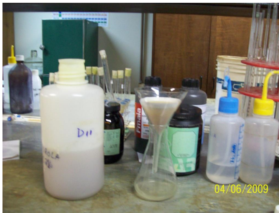
Figura 4.9: Amostra de extrato lixiviado, sendo filtrada
