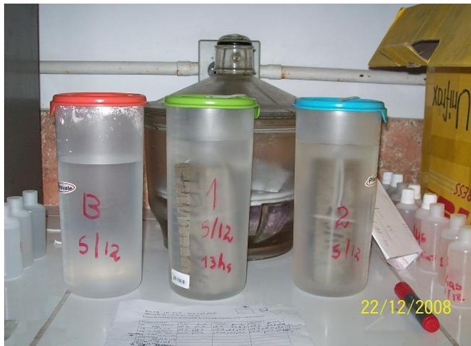
Figura 4.8: Ensaio do monólito conforme a norma NEN 7345(1995).
