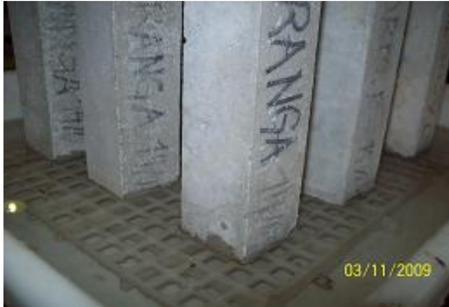
Figura 4.10 - Corpos-de-prova em ensaio de absorção por capilaridade
