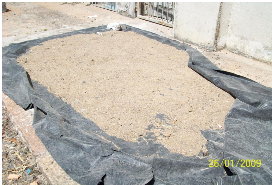
Figura 4.4: Secagem do sedimento sobre lona
