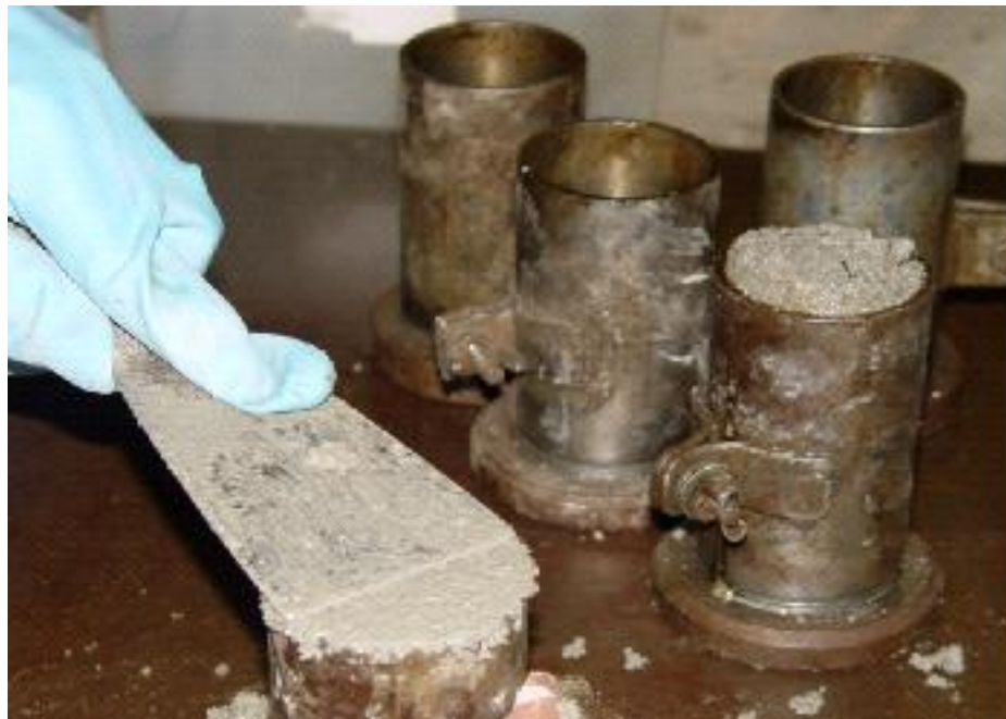
Figura 4.16 – Moldagem dos corpos-de-prova cilíndricos.
