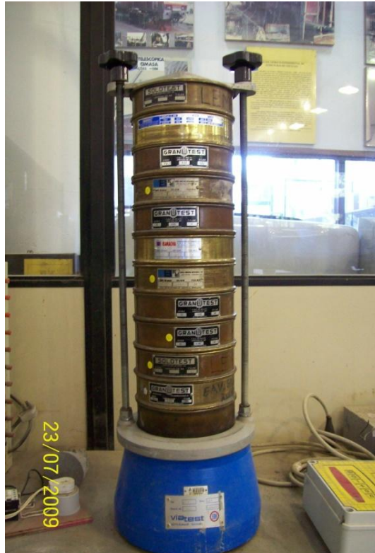
Figura 4.6 – Série de peneiras utilizada no ensaio de distribuição granulométrica
