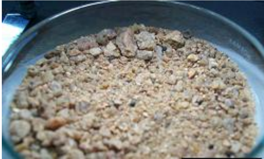
Figura 5.18: Visualização dos grãos do agregado Dilúvio D11
