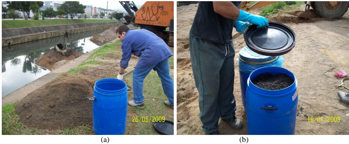
Figura 4.2: (a)Quarteamento manual e, (b) recipiente para transporte das amostras.
