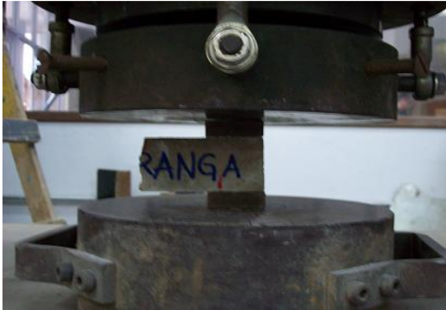
Figura 4.12: Corpos-de-prova prismáticos submetidos à compressão axial.
