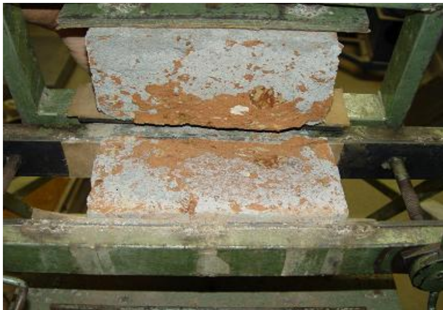
Figura 6.11: Irregularidades do bloco cerâmico com imperfeições na sua composição
