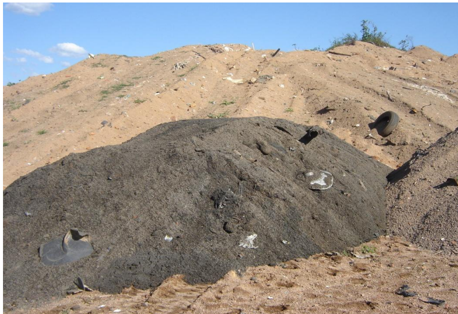
Figura 4.3 Aterro de Inertes na Serraria: contraste na cor do sedimento, conforme o tempo de deposição: sedimento mais recente, com forte tonalidade escura.
