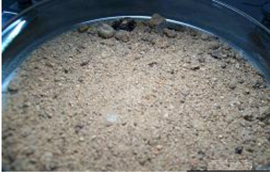
Figura 5.15: Visualização dos grãos do agregado Dilúvio D10
