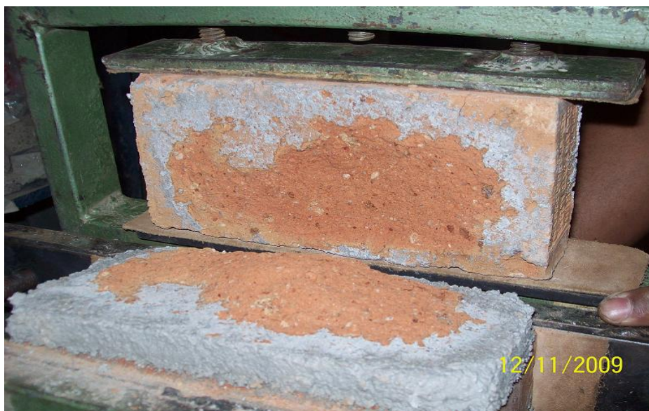
Figura 6.9: Aspecto do bloco cerâmico após o ensaio de aderência das juntas.
