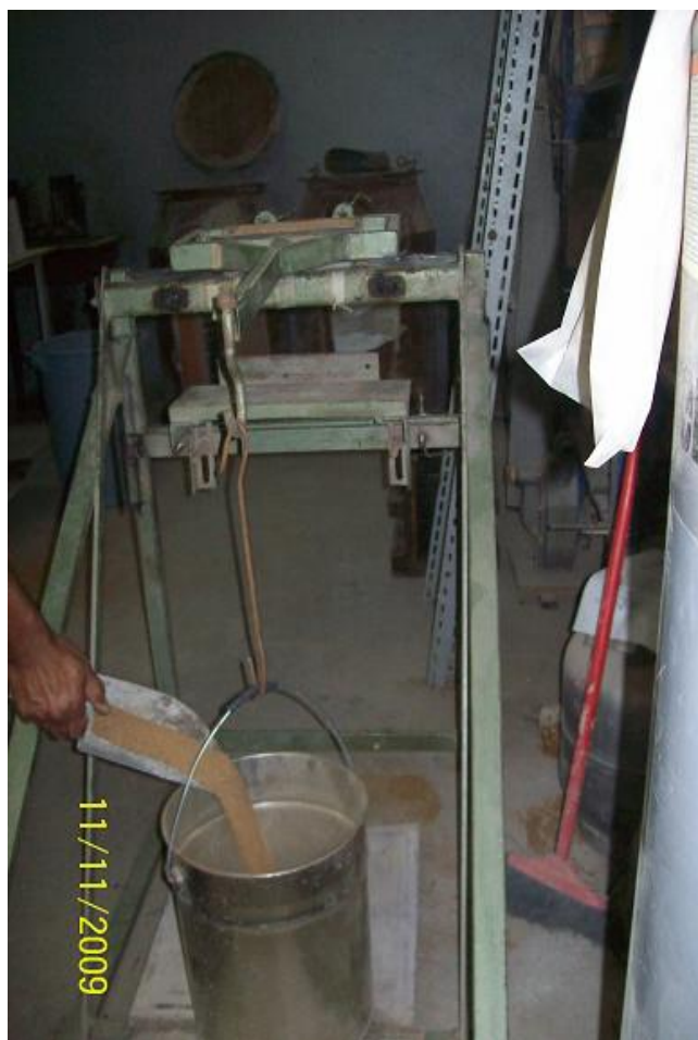
Figura 6.12: Ensaio de aderência das juntas em andamento.
