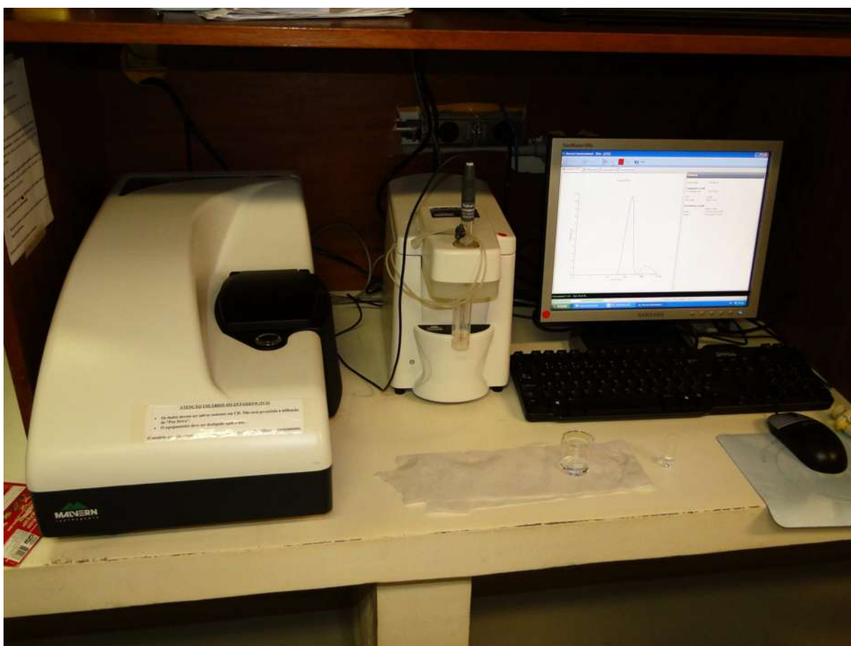
Figura 24: Modelo do ZetaSizer Nano da Malvern utilizado nas medidas de Potencial Zeta.
