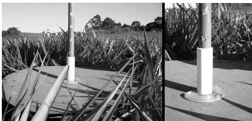
Figura 4. Ilustração e utilização do prato ascendente ou disco medidor para as avaliações da leitura comprimida.
