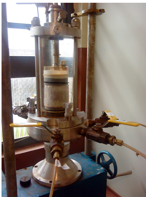
Figura 8 Câmara de compressão triaxial com montagem da amostra de solo.
