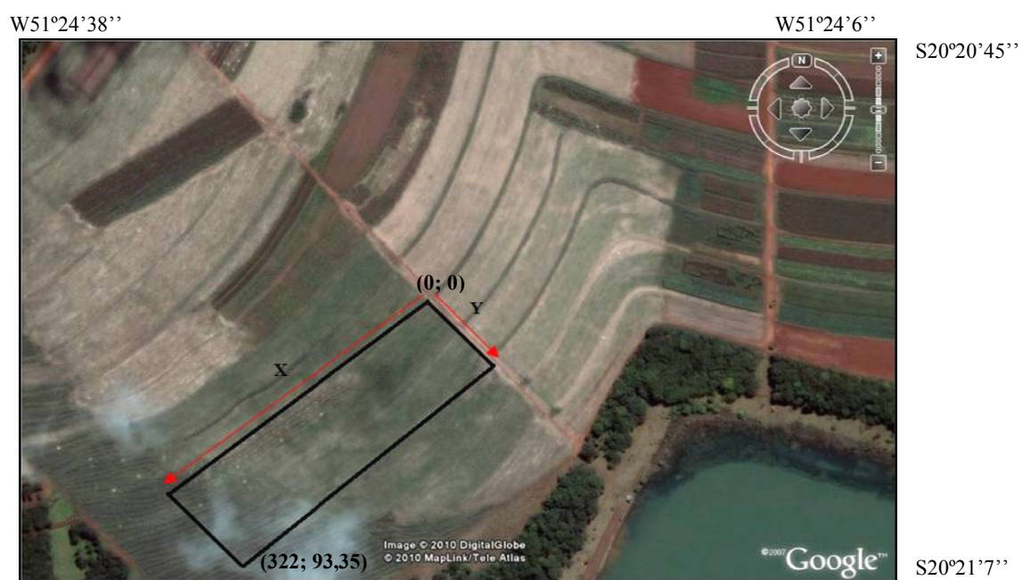
Figura 7: Esquema da malha experimental de campo com os 120 pontos amostrais.
