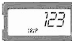
Fig. 33 - Contador elétrico digital usado em contadores de raios
